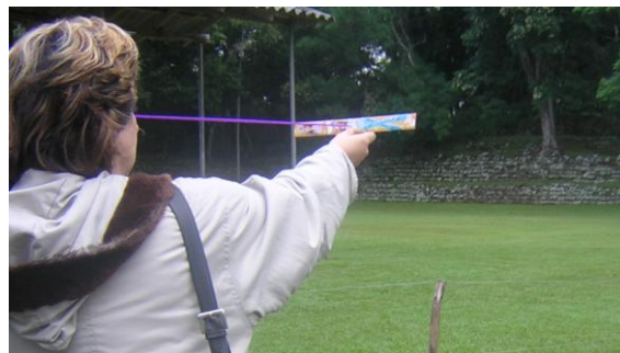
Figura 2: Usando la herramienta (una regla y un trozo de cuerda de 57 cm de longitud), se puede medir ángulos con la equivalencia “1cm = 1°”.
